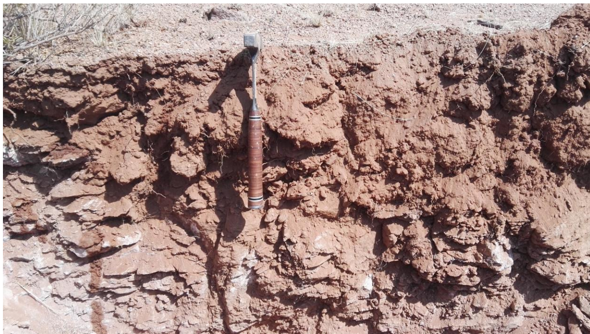
Figuur 2. Die Glenrosa grondvorm met gedeeltelik verweerde moedermateriaal wat voorkom vanaf 30cm diepte. In die geval van die Mispah grondvorm is die moedermateriaal minder verweer en is meer rots teenwoordig.
