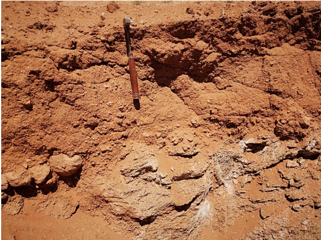
Figuur 2. Die Glenrosa grondvorm met gedeeltelik verweerde moedermateriaal wat voorkom vanaf 30-50cm diepte. In die geval van die Mispah grondvorm is die moedermateriaal minder verweer en is meer rots teenwoordig.
